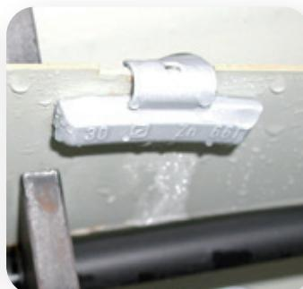
**Test comparativo** in nebbia salina tra contrappesi in acciaio e contrappesi in zinco rivestito con polvere epossidica.
